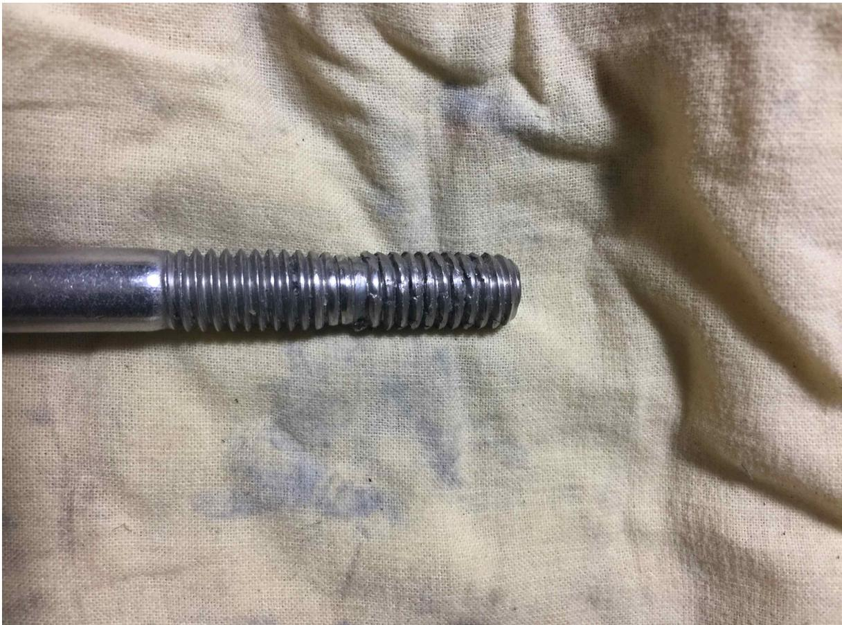
Voici ce qui arrive lorsque le montage de la plate forme se passe mal : bateau non aligné et en dévers, vis non nettoyées et non graissées et lorsque l'inconscient force comme un âne pour visser coûte que coûte les vis de fixation de poutre en travers...A la vue de la vis vous pouvez aisément imaginer l'état des filets des inserts de coque...D'où l'importance d'une :
