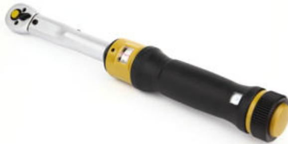
Une **clé dynamométrique** est un outil qui permet de contrôler le couple de serrage des écrous et des vis afin que ceux-ci soient montés de manière optimale. Quelle que soit la technologie, on peut, à l'usage, classer ces clefs en deux groupes : les clefs à déclenchement qui signalent l'atteinte de la valeur du couple, et celles à lecture directe qui affichent la valeur en cours.
