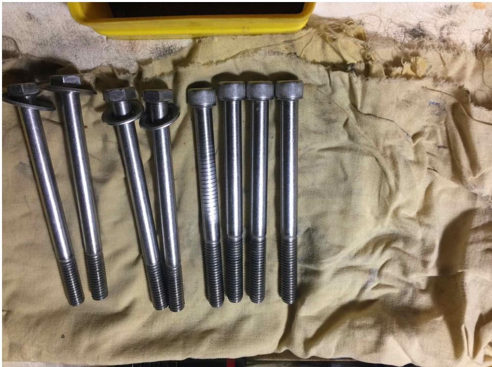
Les vis sont nettoyées et stockées dans la boîte jusqu'à la prochaine utilisation, du chiffon est également nécessaire : un peu de WD40 par dessus et on retrouve des boulons et outils en excellent état après un voyage en container ou une longue durée sans utilisation...
